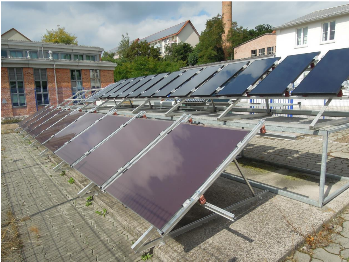
Abbildung 5.16: Freifeld-Teststand mit \mu -Si-Module (vorne) und CIGS-Modulen (hinten)
