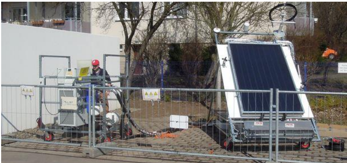
Abbildung 5.8: Quasidynamische Kollektorleistungsprüfung nach DIN EN ISO 9806
