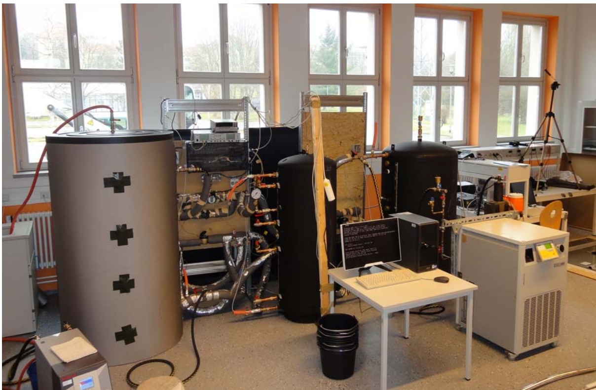
Abbildung 7: Vorversuchs-Testeinrichtung zur Ermittlung der Wärmeverluste eines Testspeichers (Bildmitte)
