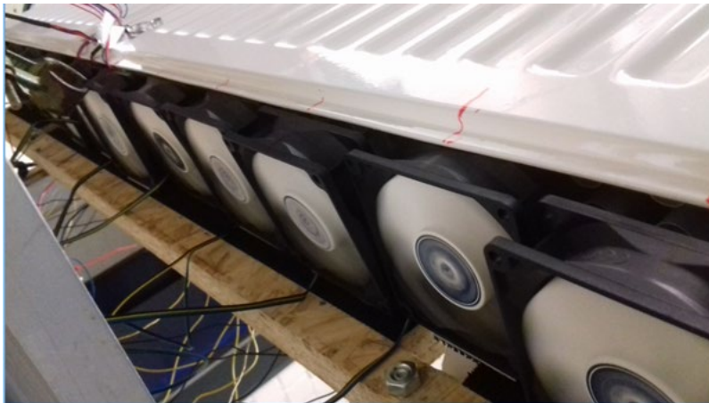
Abbildung 3: Ansicht des vermessenen Heizkörpers von unten mit Ventilatoren [5]
