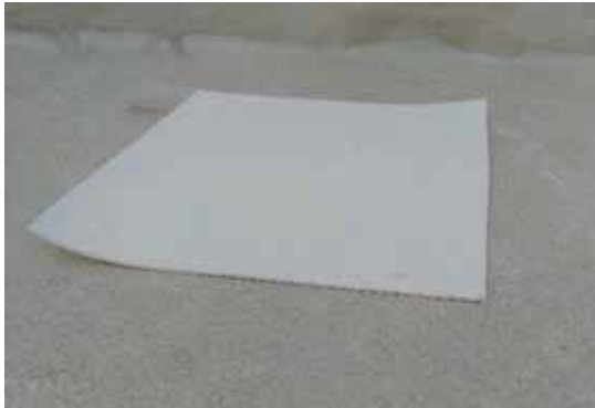
Abb. 2.2: Neue weiße Folie mit \rho_e = 0,84 im Vergleich zur Folie nach zwei Jahren Verwitterung \rho_e = 0,6
