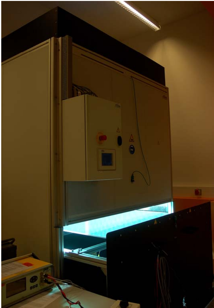
Abbildung 10: Dauerlichtsonnensimulator am in.RET (Foto: Voswinckel)
