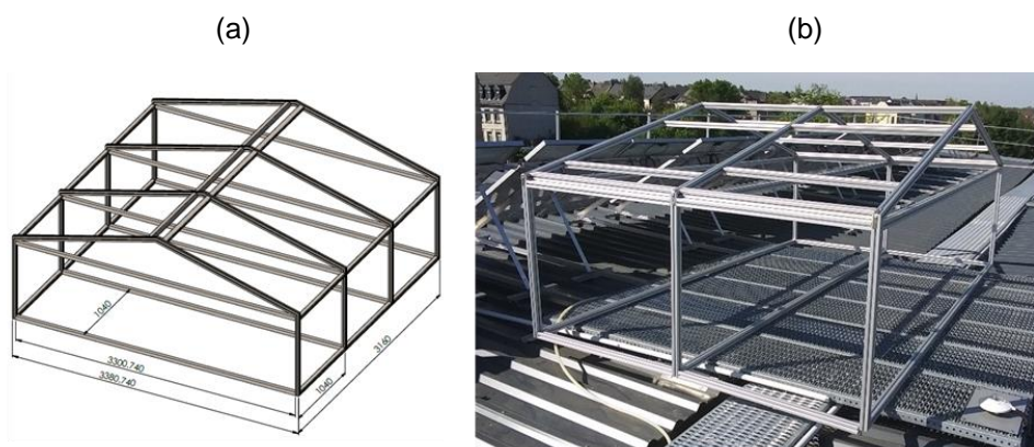
Abb. 6: Versuchsstand zur Erprobung der PVT-Kollektoren: (a) Konstruktionsentwurf und (b) Tragskelett
