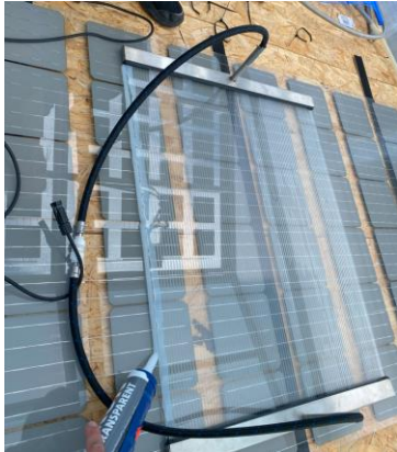
Abb. 5: Klebeversuche PP auf Glas zur Entwicklung der Füge-technologie PV-WÜ
