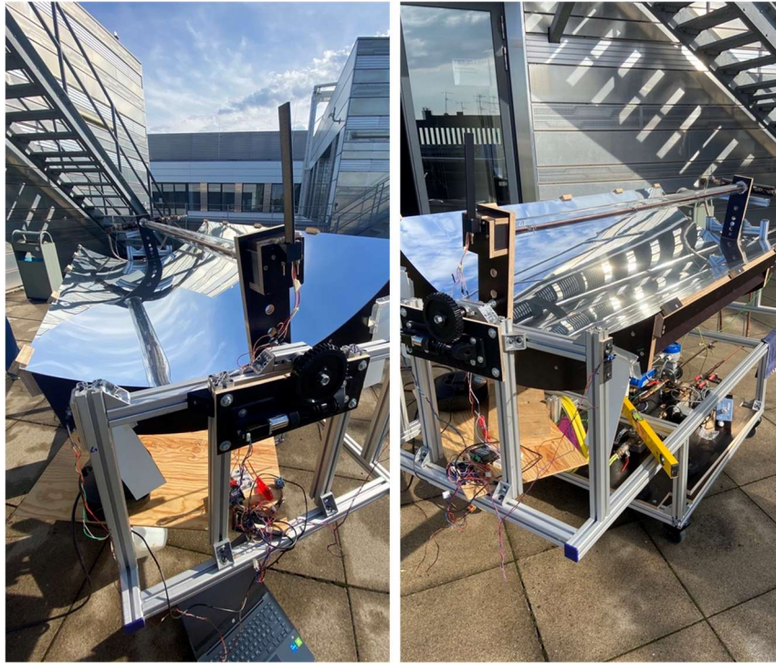
Abbildung 9 – Parabolrinne im Feldversuch. links: Verfahren der Parabolrinne in die 0°-Stellung. rechts: Ausrichtung des Höhenwinkels (Altitude)
