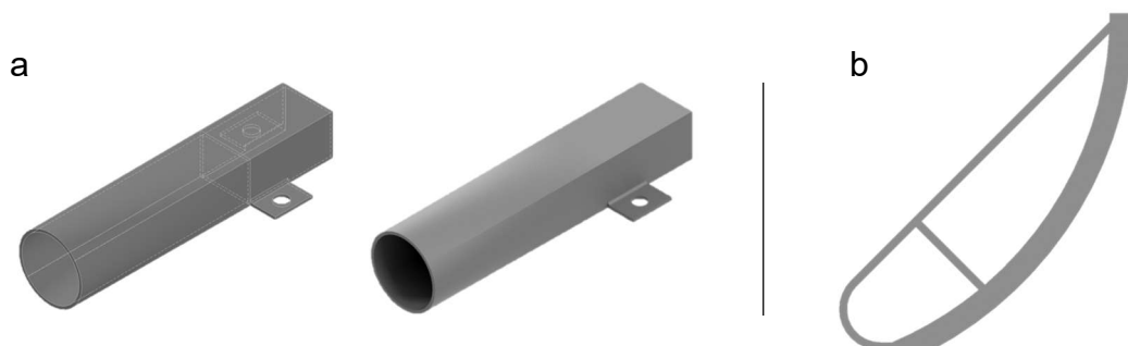
Abbildung 3 - Orthogonal- und Vorderansicht der Parabolrinne in 0°-Stellung mit Infrarotsensorhalterung (a) und Reflektoren (b)
