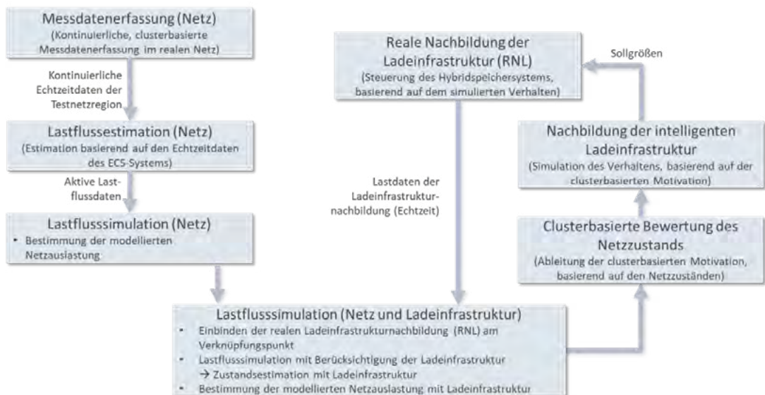
Abb. 4: Grundstruktur des Hardware-in-the-Loop Echtzeitdemonstrators
