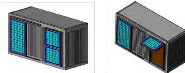
Abb. 6: EnShade-Versuchsstand für Großdemonstratoren
