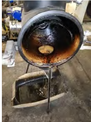
Abb. 1: Teerablagerungen in einem älteren Notfilter vor dem BHKW-Motor einer Holzgasanlage nach der eigentlichen Produktgasreinigung als Folge von feuchtem Brennstoff, Hohlbränden oder anderen Prozessstörungen.
