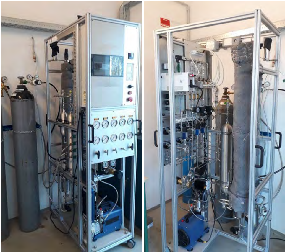
Abbildung 1: Mini-Anlage zur Methanol-Synthese
