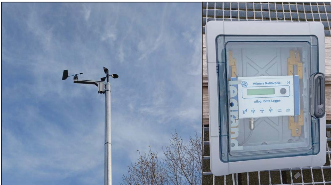
Abb. 2: Feldmesseinrichtung mit Datenlogger
